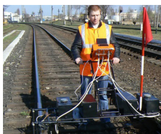
На фото: деятельность оператора ультразвукового контроля
